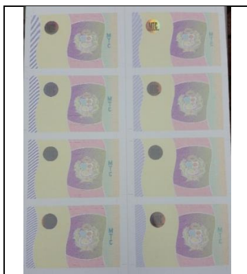
FIGURA N°9. El papel sintético micro poroso lleva adheridos 8 hologramas en cada hoja, una por tarjeta, ubicados en la parte superior izquierda del anverso, sobre el espacio asignado a la fotografía.
