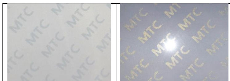
FIGURA N°10. Impresión de las siglas “MTC” con “tinta ópticamente variable traslúcida”, que cambia de color según el ángulo de observación
